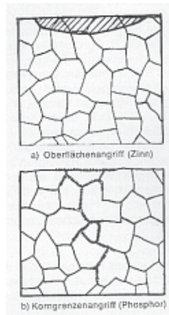
Bild 1: Topochemischer Unterschied bei Korrosionsangriffen von Platin (nach J. Fischer)
