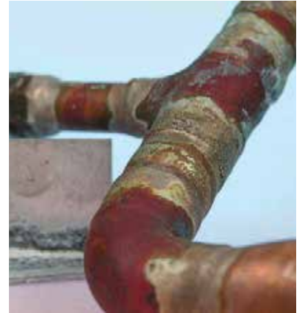
Flussmittelreste der Typen FH 10 und FL 20 auf Messing/Kupfer und Aluminium
